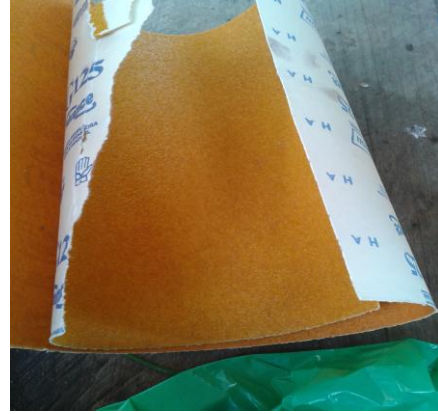
Imagem 5: lixas usadas para fazer o primeiro acabamento. Fonte: imagem cedida por Cleusiane Costa Cruz
