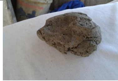
Imagem 2: Barro (argila) depois de misturado ao caripé.
