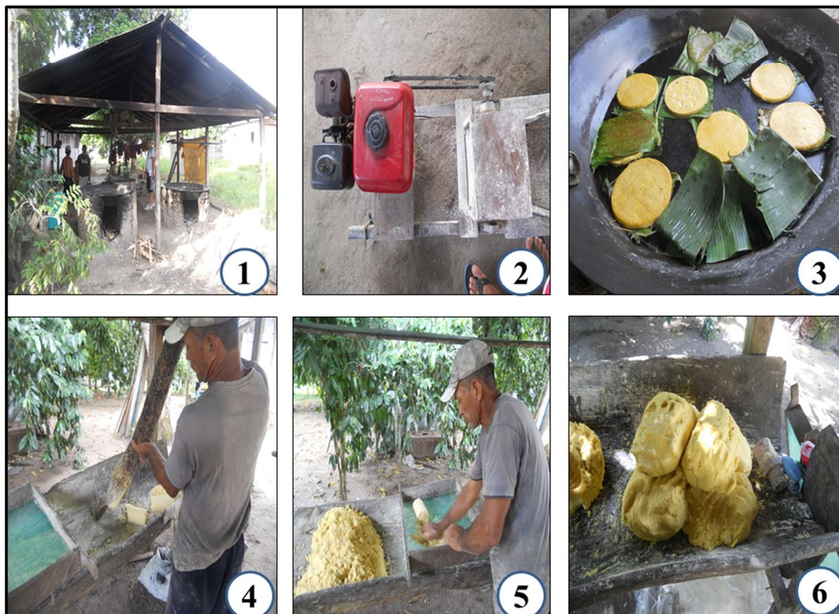
**Figura 03:** Agroindústria caseira dos agricultores da comunidade do Maranhão: 1 (casa de farinha); 2 (motor triturador); 3(forno); 4 (tipiti); 5 (peneira); 6 (garera).
