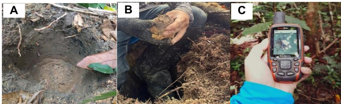
Figura 3: Etapas da coleta das amostras preservadas: (A) Abertura de mini trincheira; (B) Coleta de solo com a estrutura preservada em anel volumétrico; (C) Georreferenciamento com equipamento GPS. Fonte: Arquivo pessoal.
