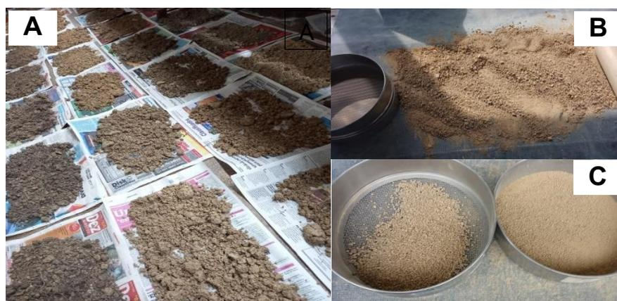
Figura 5: Processo para obtenção de TFSA: (A) Secagem do solo ao ar; (B) Destorroamento das amostras; (C) Peneiramento do solo destorroado. Fonte: Arquivo pessoal.
