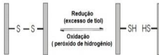
Figura 2: Alisamento por processo de redução e oxidação.
