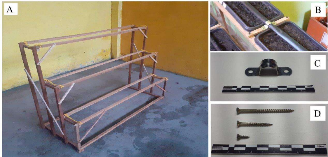
Figura 7 - A) Vista do aspecto final da montagem da base de madeira; B) Uso das abraçadeiras de 20mmna linha de irrigação; C) Parafusos utilizados para a fixação dos componentes da estrutura da base demadeira; D) Modelo de abraçadeiras utilizadas para fixar as linhas de irrigação na estrutura.
