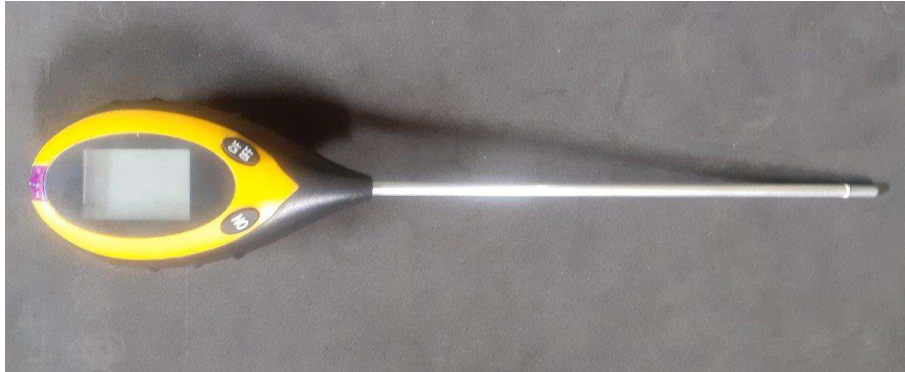
Figura 9 - Modelo de aparelho medidor para solo utilizado no levantamento de dados manuais.
