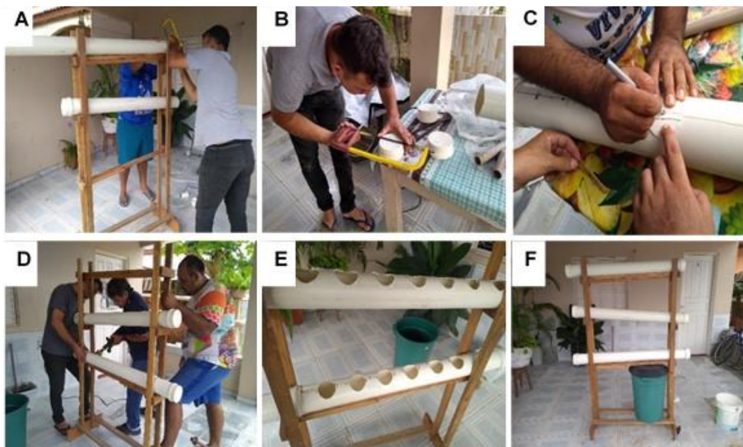
Figura 3: Construção do sistema hidropônico móvel. A. Encaixe dos canos pvc (100 mm) na arte de madeira. B. Acabamento dos detalhes do corte do cano pvc (100 mm). C. Medição. D. Arrebitagem. E. Visão superior e D. Visão frontal do Sistema hidropônico móvel finalizado.
