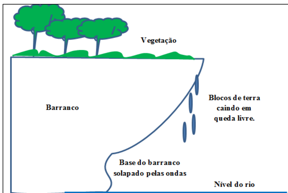
Figura 5: Processo de desabamento.
