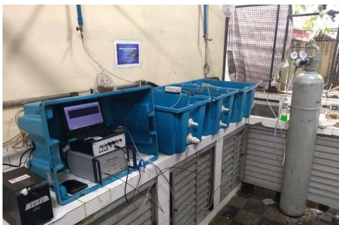
**Figura 3.** Demonstração do sistema experimental. Os animais foram submetidos durante 24 h a dois tratamentos: hipóxia ( $0,57 \pm 0,072 \text{ mgO}_2\cdot\text{L}^{-1}$ ) e normóxia ( $7,38 \pm 0,08 \text{ mgO}_2\cdot\text{L}^{-1}$ ). Detalhes para os dois tanques experimentais (normóxia e hipóxia) e para o tanque de troca de água diária. Assim como para o sistema automatizado DAQ M acoplado a válvula solenoide para a conexão automática com o nitrogênio gasoso.
