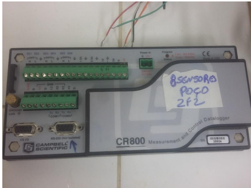
Figura 10 – Sistema de aquisição de dados modelo CR 800
