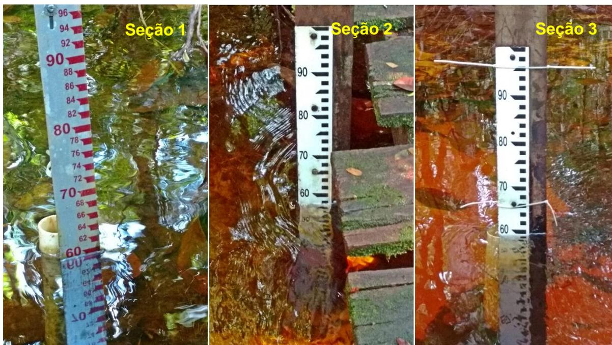
Para garantir o registro das menores variações das cotas limnimétricas definiu-se o intervalo de registros dos linígrafos em 15 minutos. A frequência curta também favorece a análise dos erros associados a variação da pressão atmosférica, corrigido através de compensação barométrica, variável registrada em barômetro externo na torre K34.
