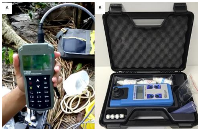
Figura 9- Sonda multiparâmetro HANNA HI 98194 e turbidímetro HANNA HII 93703
