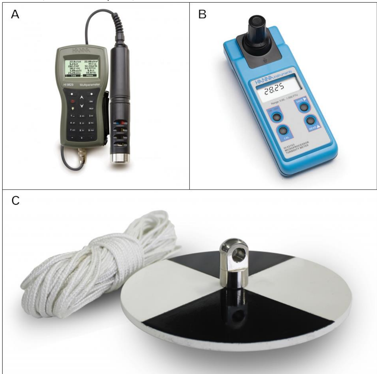
Figura 07: Aparelhos utilizados para a medição dos dados limnológicos. A: Medidor multiparâmetro com sonda; B: Turbidímetro portátil; C: Disco de Secchi.
