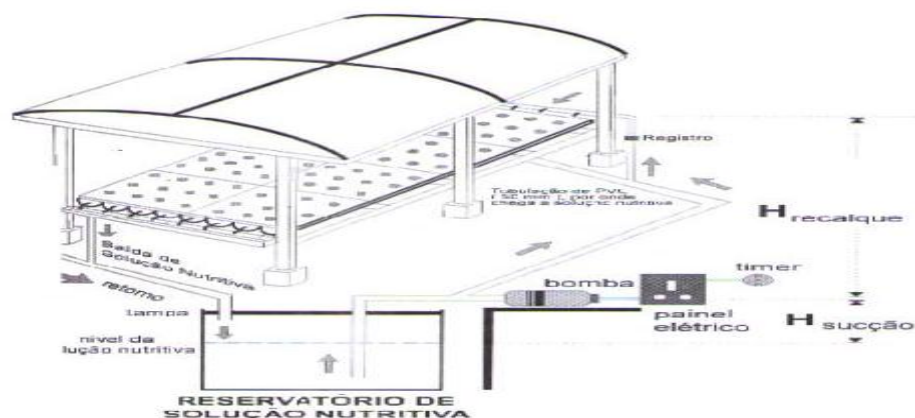
Figura 1: Desenho esquemático de um sistema NFT
