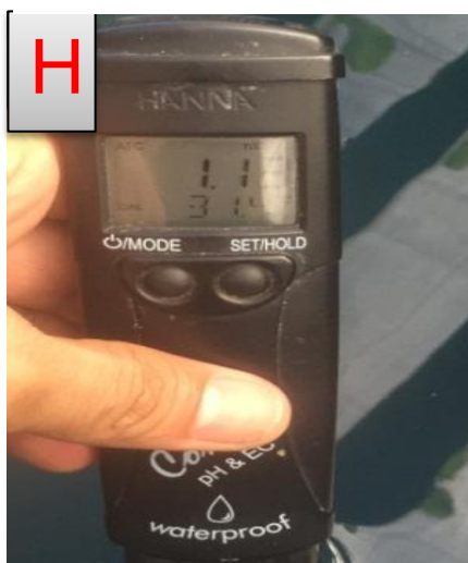
Figura 8: (H): Medidor digital com a função de verificar a CE, o pH e a temperatura; (I): Temporizador analógico ; e (J): Balança digital.
